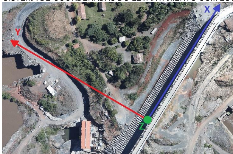
FIGURA 38 – SISTEMA DE COORDENADAS DO LEVANTAMENTO COM ESTAÇÃO TOTAL
