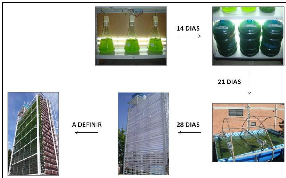
FIGURA 11 – FLUXOGRAMA PARA INOCULAÇÃO DO FOTOBIORREATOR
