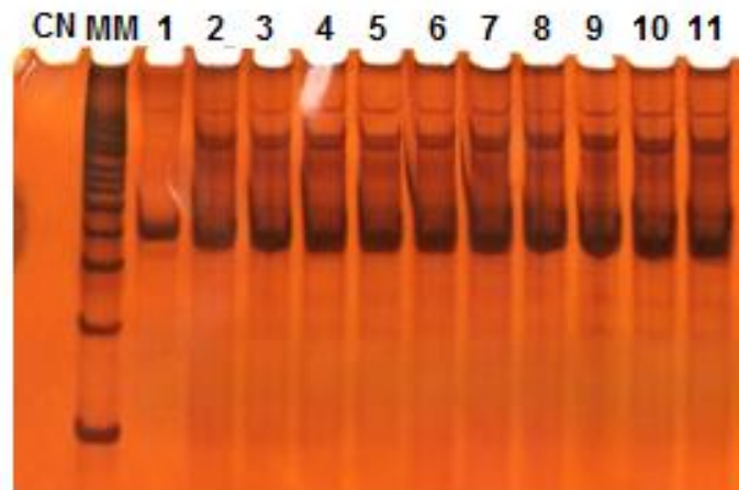
FIGURA 6 - GEL DE PCR DE COLÔNIA EMPREGANDO-SE OS INICIADORES MGF0/MGF2. MM: marcador de massa 100 pb, 1: fragmento de DNA de aproximadamente 350 bp purificado, 2 – 11: colônias de bactérias E. coli que continham o inserto eletroporado.
