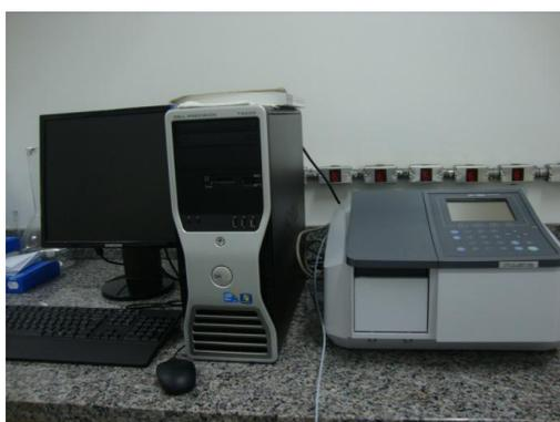
FIGURA 24 - Espectrofotômetro UV-Vis.
