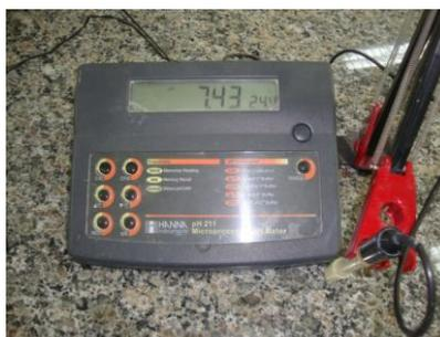
FIGURA 20 – pHmetro utilizado para a verificação do pH das rações.
