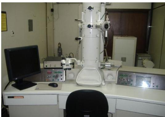
FIGURA 6 - MICROSCÓPIO ELETRÔNICO DE TRANSMISSÃO (MET).
