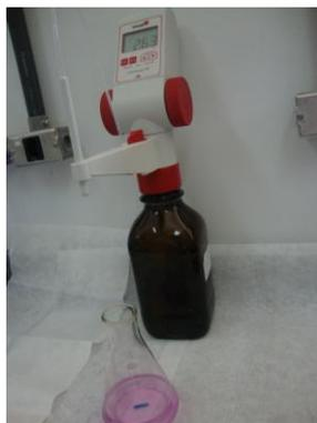
FIGURA 19 – Ensaio para verificação do teor de acidez.
