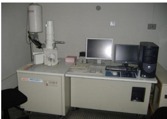
FIGURA 5 - Microscópio eletrônico de varredura
