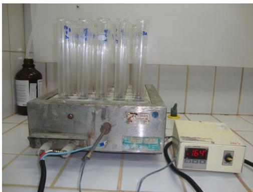
FIGURA 11 – Tubos no processo de digestão da matéria orgânica para determinação de proteínas.
