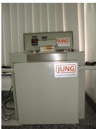
FIGURA 9 - Mufla utilizada nos testes para determinação de cinzas.
