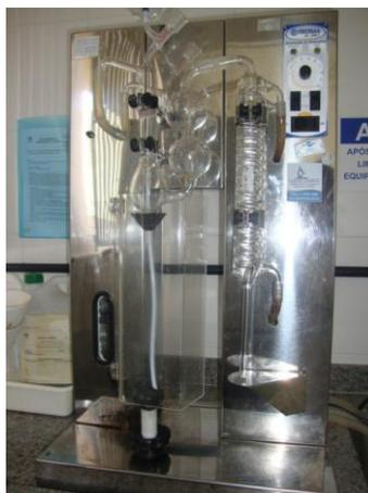
FIGURA 12 – Destilador de Nitrogênio Tecnal, TE 036/1.
