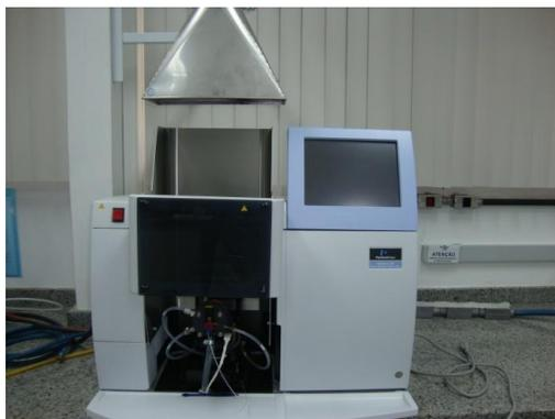
FIGURA 23 – Espectrômetro de Absorção Atômica.
