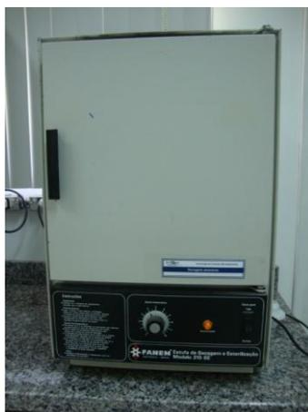
FIGURA 8 - Estufa utilizada nos testes para determinação de umidade.
