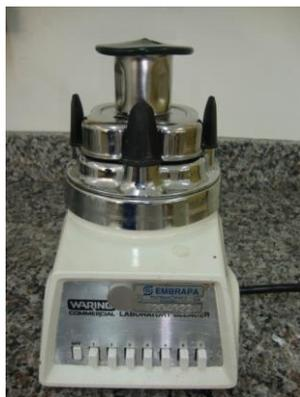
FIGURA 22 - Triturador de bancada Waring.
