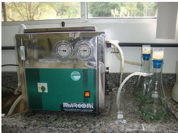
FIGURA 14 – Filtração das amostras de Fibras após precipitação.
