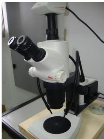
FIGURA 16 – Lupa estereoscópica utilizada para contagem dos microcrustáceos no ensaio de toxicidade.
