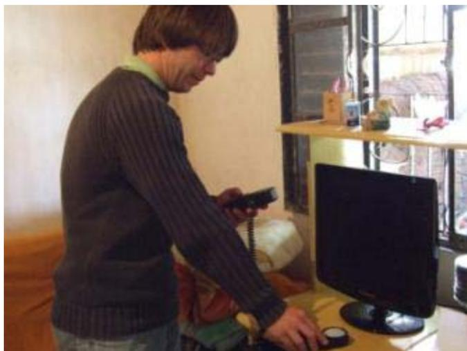
Figura 4. 9: Medição da luz sobre a mesa do computador realizada com o luxímetro
