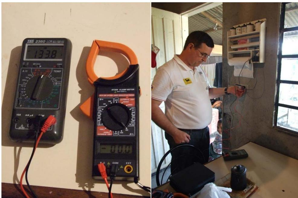
Figura 02: A esquerda multímetro digital utilizado na medição. À direita Prof. Ewaldo realizando medida da variação de tensão na tomada da cozinha.
