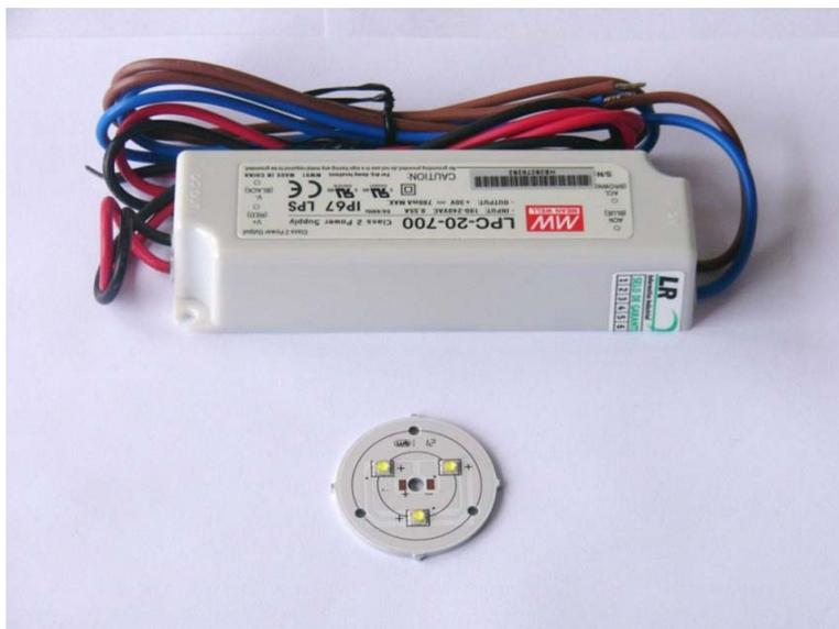
Figura 2. 19: Exemplo de LED, que necessita do uso do drive.
