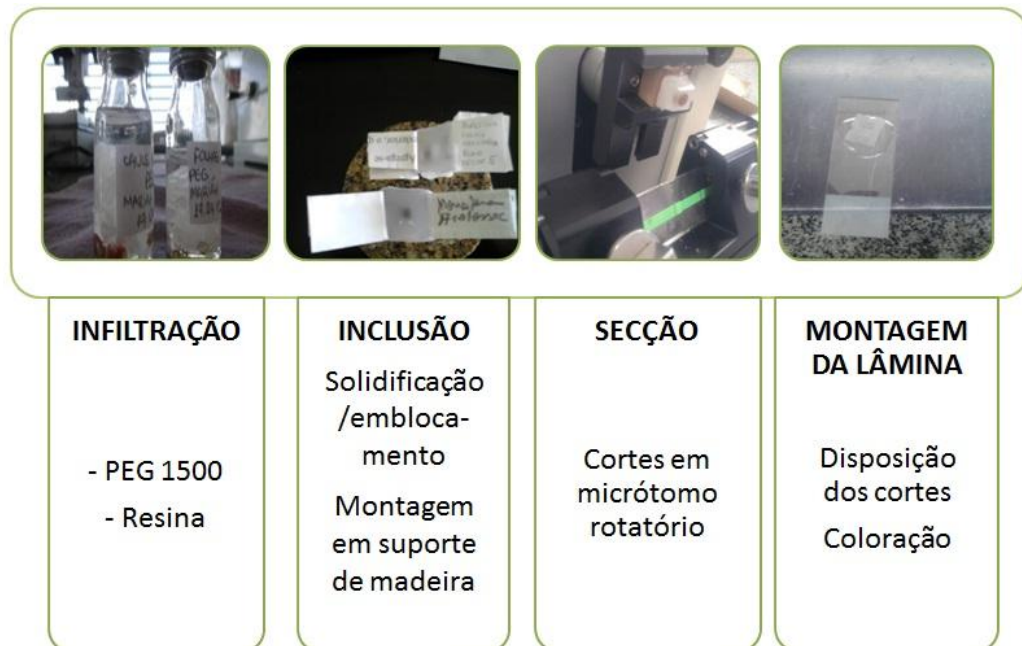
FIGURA 11 - ETAPAS DE PREPARO DAS LÂMINAS PERMANENTES E SEMI-PERMANENTES POR INFILTRAÇÃO E INCLUSÃO EM HISTORESINA E PEG 1500 FONTE: O Autor (2011)
