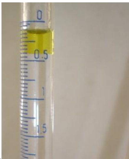
FIGURA 34 – OBTENÇÃO DO ÓLEO ESSENCIAL E LEITURA NO TUBO DE GRADUAÇÃO EM APARATO DE CLEVINGER MODIFICADO FONTE: O Autor (2011)
