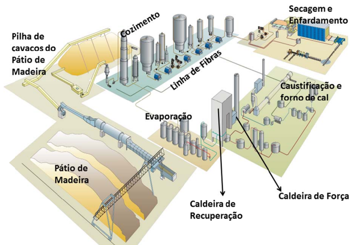
Figura 12 - Ilhas de processo de uma fábrica de celulose
