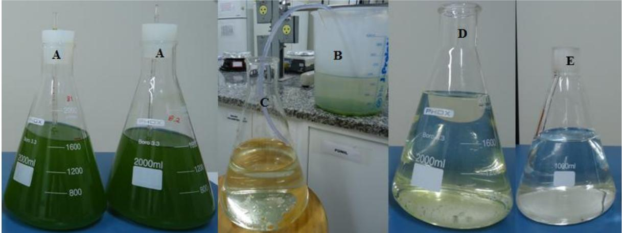
FIGURA 08 – A – CULTIVOS DE MICROALGAS; B – RECUPERAÇÃO DA BIOMASSA; C – MEIO CLARIFICADO; D – MEIO CLARIFICADO SEM FILTRAR; E – MEIO CLARIFICADO FILTRADO
