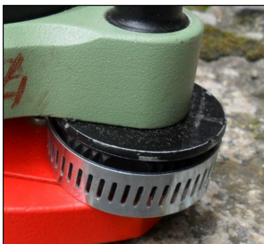
FIGURA 21 - PARAFUSO CALANTE TRAVADO POR MEIO DA PEÇA DESENVOLVIDA E DA ABRAÇADEIRA
