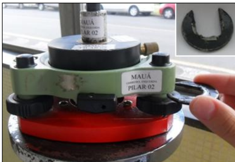
FIGURA 18 - PEÇA UTILIZADA PARA TRAVAR O PARAFUSO CALANTE
