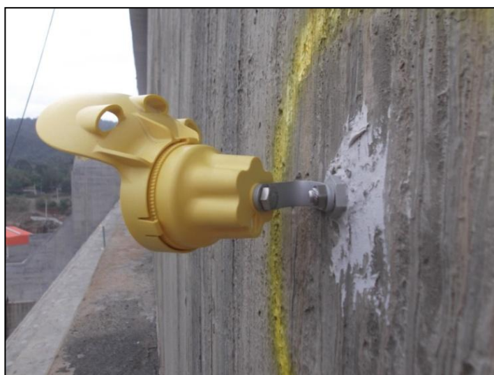
FIGURA 37 – PRISMA GPR112 PRESO COM UM SUPORTE EM FORMA DE “U”
