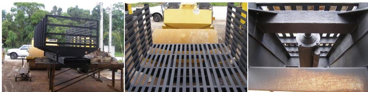
FIGURA 23 - Detalhes da caçamba basculante para o lançamento de até 60 RRL (novembro de 2009)
