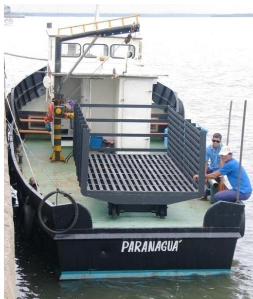
FIGURA 24 - Rebocador Genesis I com a caçamba basculante para o lançamento de até 60 RRL (janeiro de 2010)
