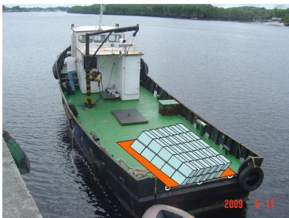
FIGURA 22 – Foto-ilustração do rebocador e perspectiva da caçamba basculante (em laranja) contendo 60 RRL (em azul)
