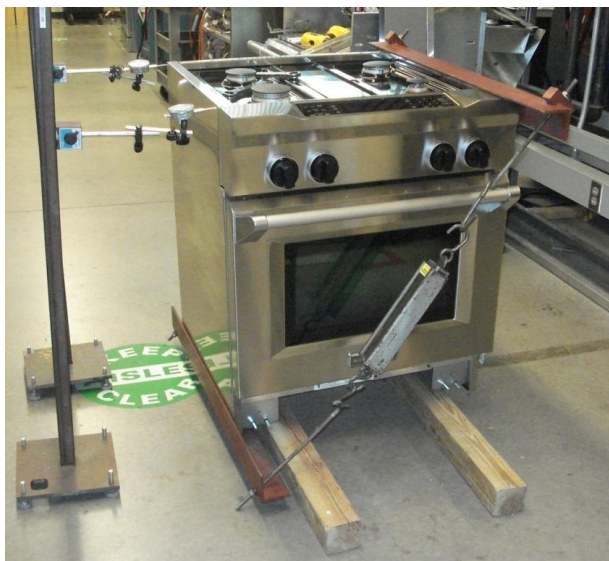
Figura 3 - Disposição para o teste de carga diagonal
