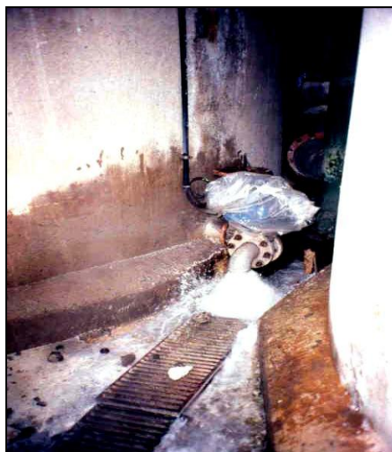
FIGURA 16 – PERDA DE FIBRAS EM DERRAMES DE TANQUES FONTE: FOELKEL,2007
