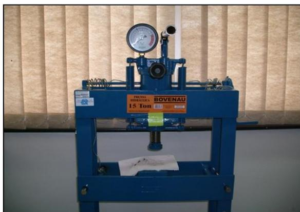
*Figura 5: Foto da prensa hidráulica utilizada na síntese das pastilhas.*
