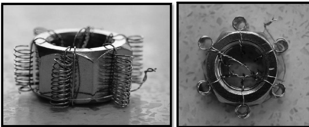
FIGURA 26 – APARATO INOVADOR PARA DISSOLUÇÃO DE MINICOMPRESSOS – VISTA LATERAL E SUPERIOR
