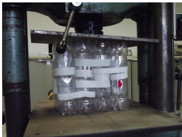
Figura 44 – Exemplo de ensaio para teste de resistência do pufe
