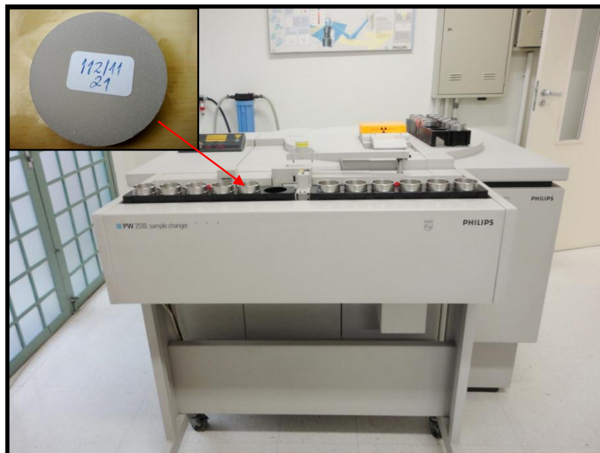
FIGURA 11 - Equipamento da PHILIPS modelo PW 2510, em destaque (canto esquerdo) pastilha que é submetida à análise.
