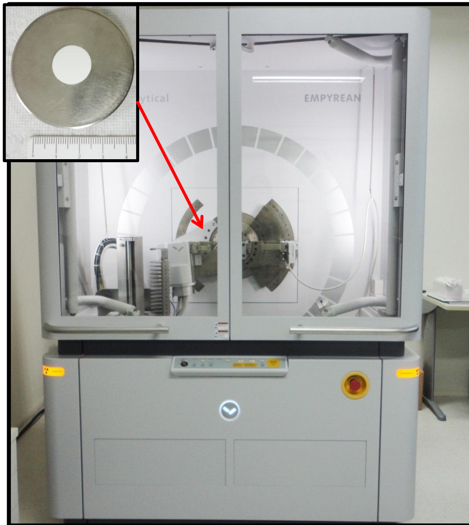
FIGURA 9 - Difratorômetro da PANalytical, modelo EMPYREAN, no detalhe (canto esquerdo) placa com pó prensado.
