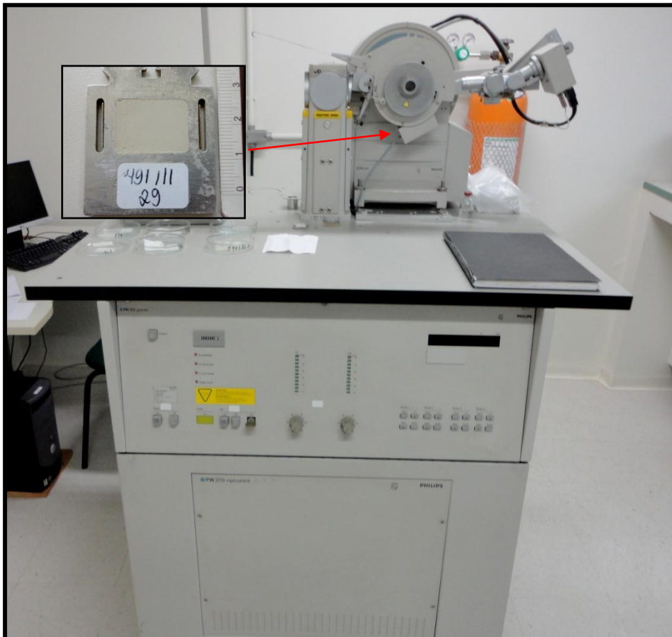
FIGURA 8 - Difratômetro da Philips modelo PW 1830, no detalhe (canto esquerdo) placa com pó prensado.
