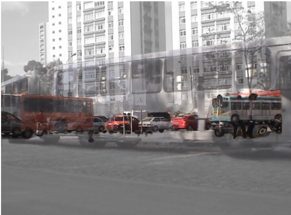
FIGURA 19 – SUPERPOSIÇÃO DAS FATIAS DE TEMPO DO ENSAIO 1, EVIDENCIANDO-SE ELEMENTOS FIXOS APRESENTADOS EM TONS DE CINZA E MÓVEIS NA COR ORIGINAL NA FOTOGRAFIA
