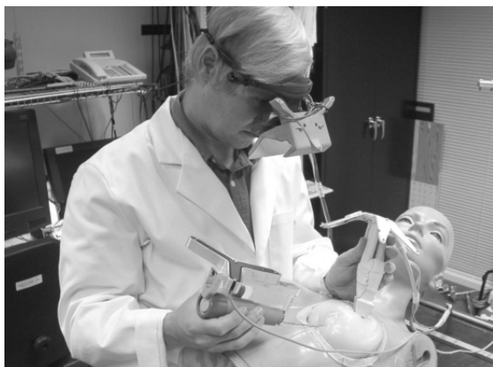
Figura 1. 22: Video see-through HMD em simulação de biópsia do seio Fonte: State et al. (2003)
