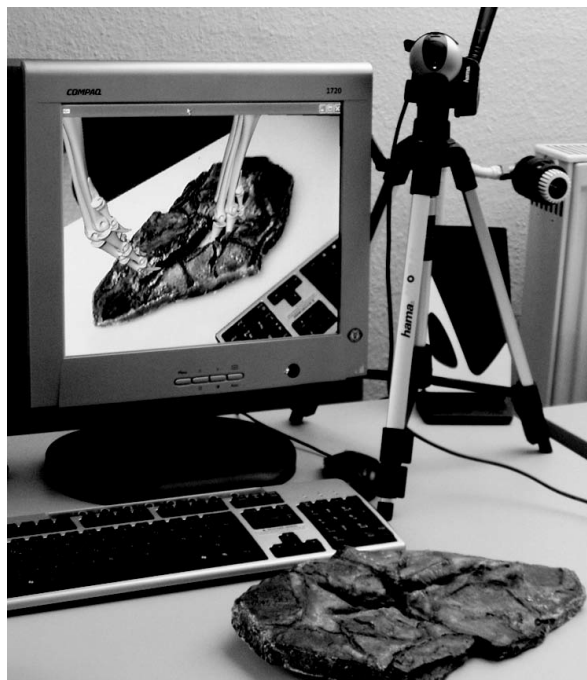
Figura 1. 8: Exemplo de screen-based video see-through display Fonte: Bimber e Raskar (2005a)
