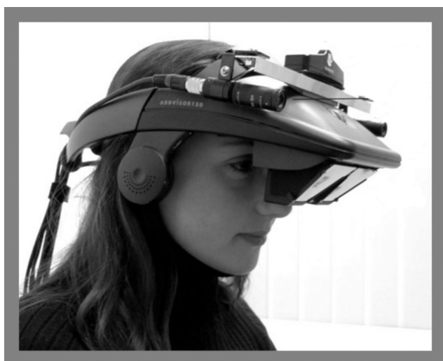
Figura 1. 5: Video see-through HMD desenvolvido pela empresa Saab Tech Fonte: http://www.jvrb.org/archiv/34/ (2010)
