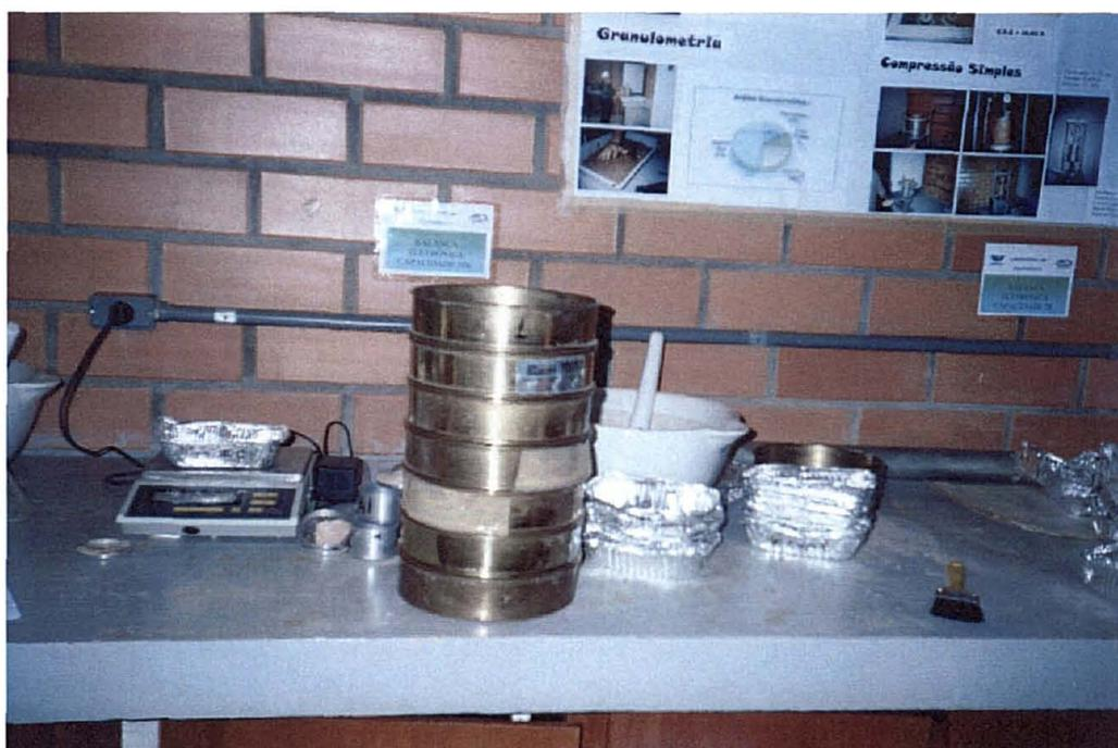
FIGURA 07 – Jogo de peneiras e balança eletrônica utilizados na análise granulométrica.
