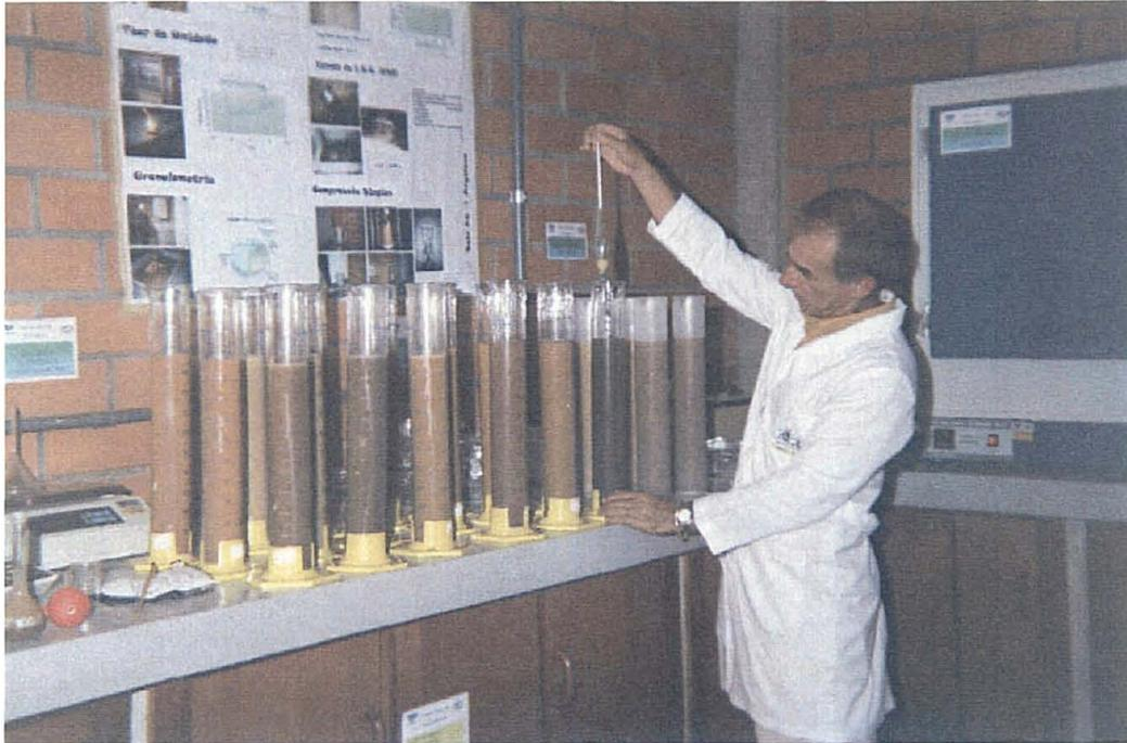
FIGURA 08 – Leitura das amostras com utilização do densímetro.
