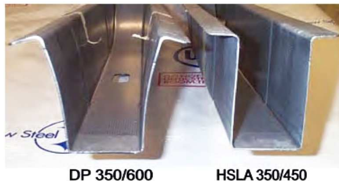
Figura 2 – Canais em diferentes materiais, estampados na mesma ferramenta. (Fonte: WorldAutoSteel, 2009)
