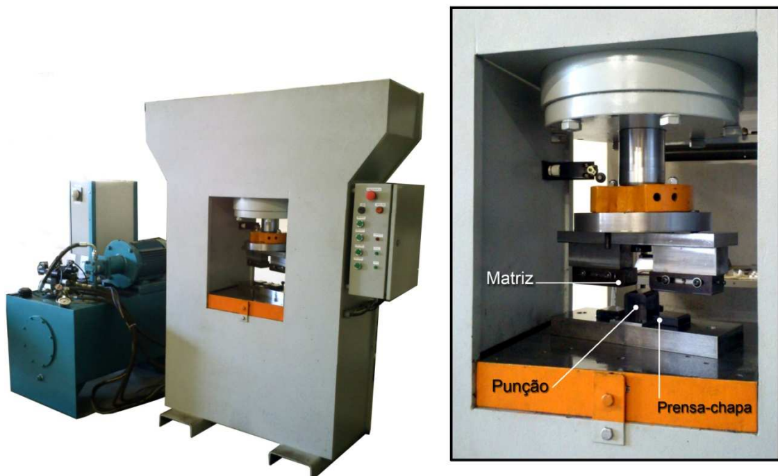
Figura 40 – Ferramenta de embutimento de canal montada na prensa hidráulica.
