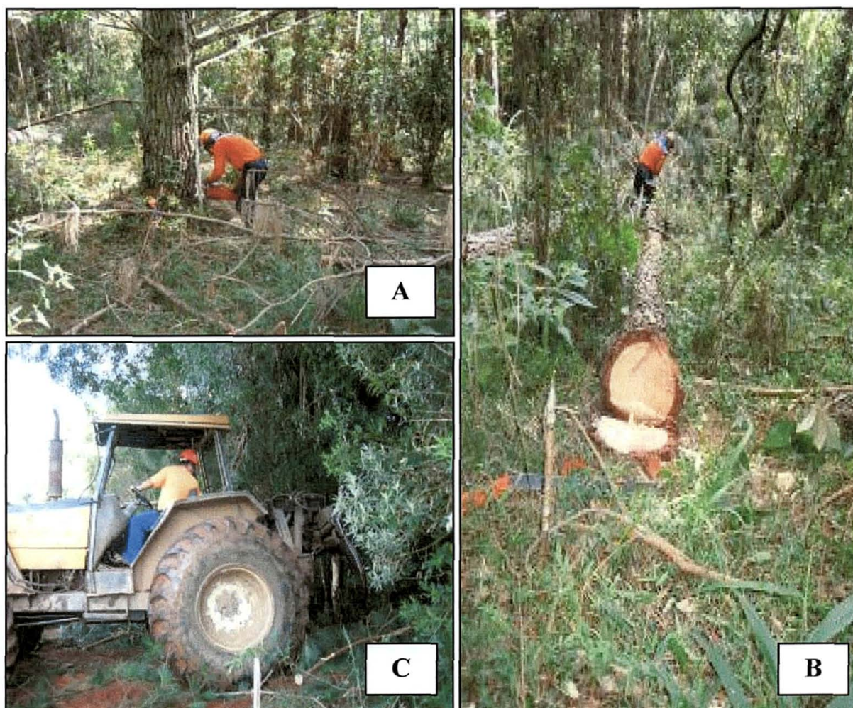
FIGURA 05 – A) Corte da árvore de pinus; B) Retirada de galhos da árvore de pinus; C) Retirada da árvore de pinus com utilização do skidder
