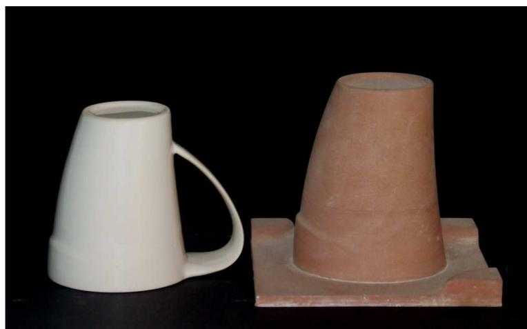
Figura 13 – Matriz usinada em poliuretano de alta densidade e peça gerada em cerâmica branca
