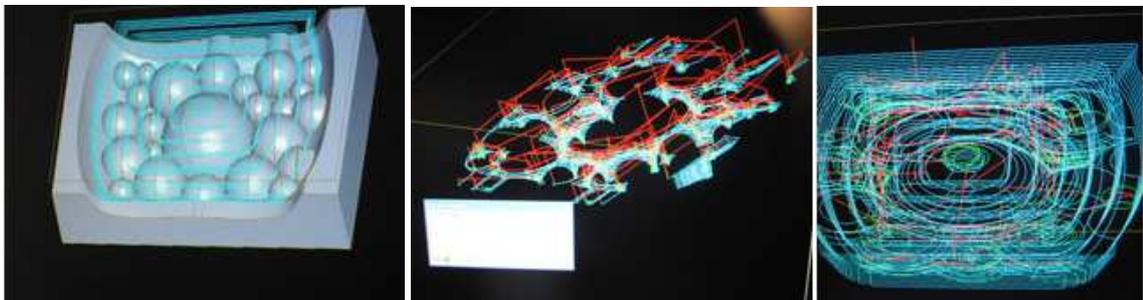
Figura 8 – Planeamento da usinagem feita no CAM
