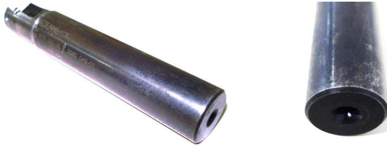
Figura 38 – Exemplo de fresa para desbaste (20mm de diâmetro e topo reto)
