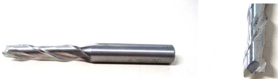
Figura 39 - Exemplo de fresa para perfilamento/acabamento (8mm de diâmetro e topo esférico)
