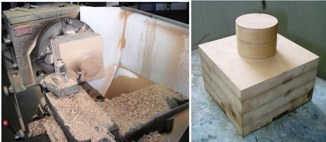
Figura 37 – Bloco em processo de desbastamento e o resultado final
