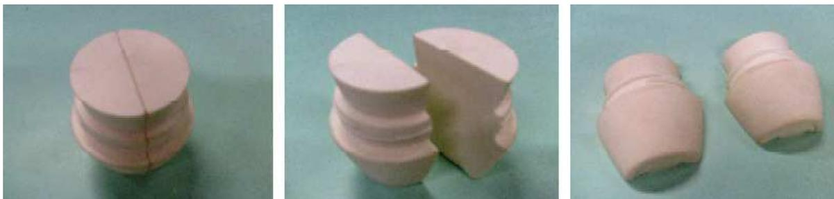
Figura 12 – Modelo feito em PU utilizando prototipagem
