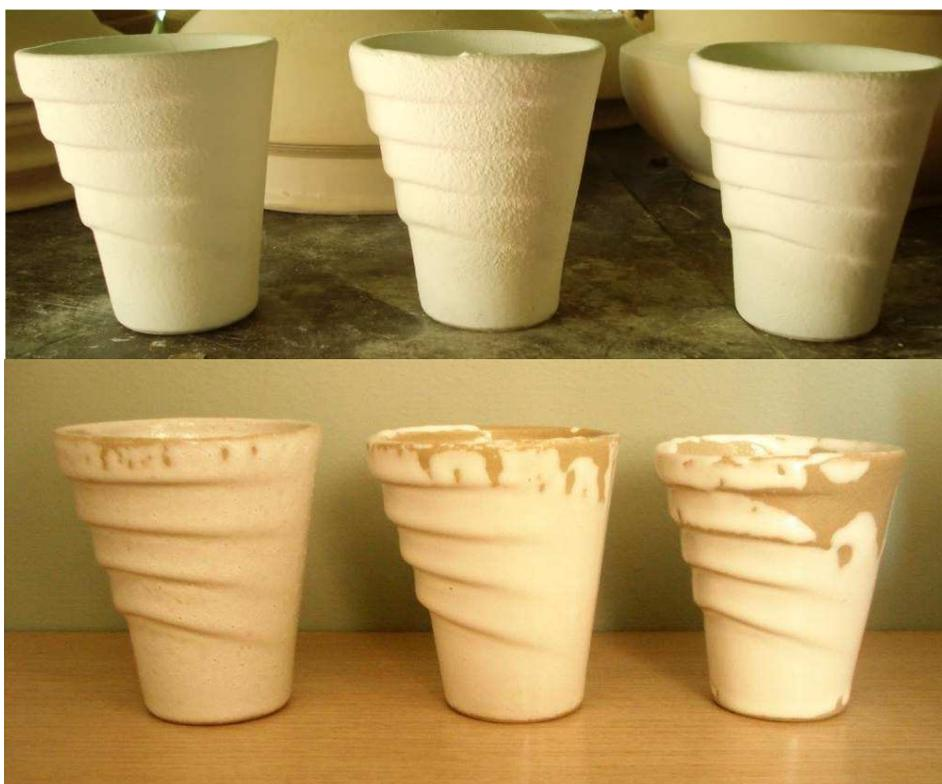
Figura 54 – Diferença entre as peças vidradas antes e depois da queima
