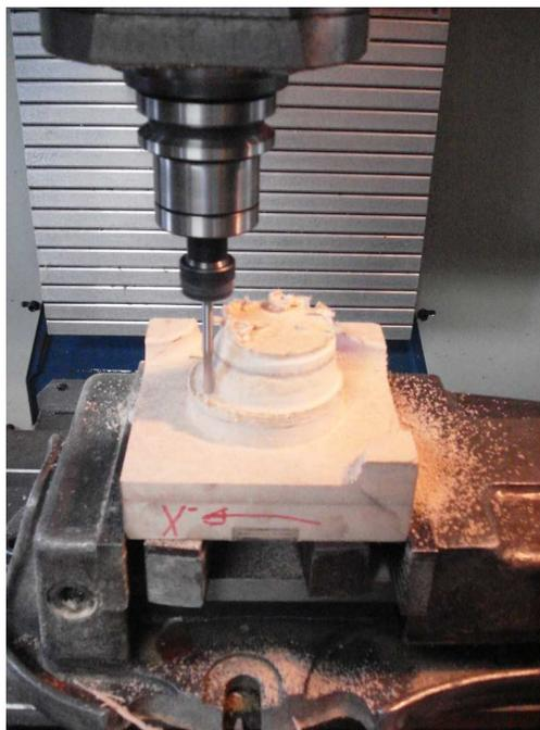
Figura 46 – Parte 2 em processo acabamento
