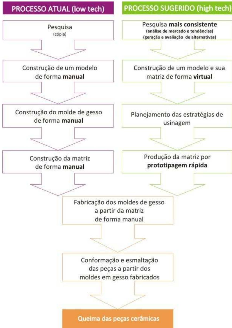
Figura 57 – Comparação de etapas dos processos tradicional e sugerido
