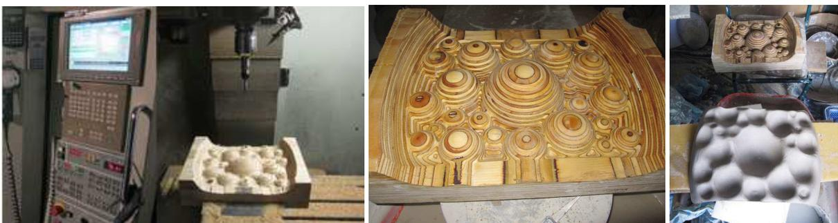
Figura 9 – Matriz de compensado sendo usinada e a confecção do seu molde em gesso
