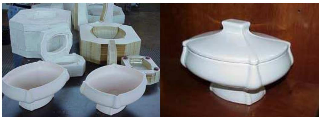
Figura 11 – Matrizes fabricadas por um processo de prototipagem rápida e sua peça final
