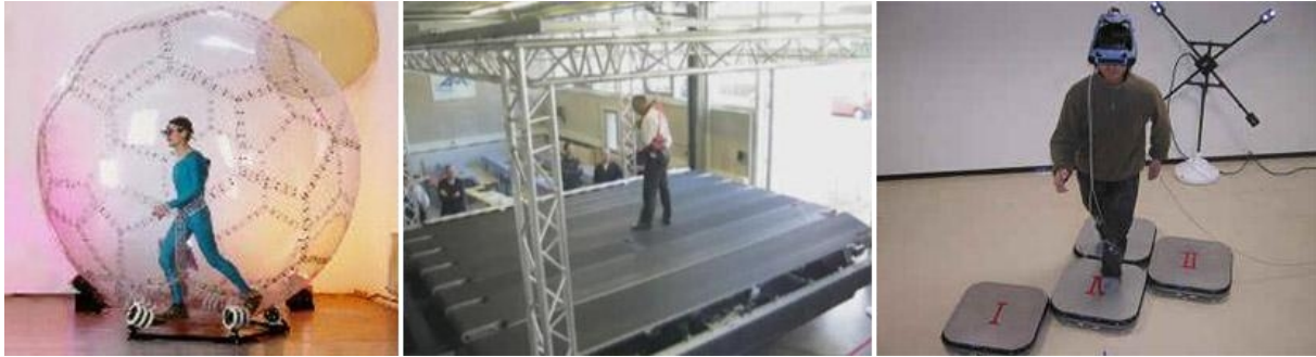
Figura 3.1: Exemplos de dispositivos de locomoção: (a) VirtuSphere, (b) CyberWalk e (c) CirculaFloor.
