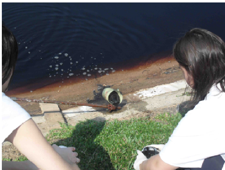
FIGURA 3.3 - COLETA DO LODO ANAERÓBIO NA LAGOA FACULTATIVA DO ATERRO SANITÁRIO DE CURITIBA
