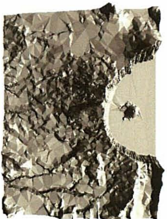
Figura 5.16: Aproximações de crater_lake-w pela distância máxima vertical para três níveis de resolução. (a) 0,5%; (b) 3%; (c) 5% de pontos da imagem original.
