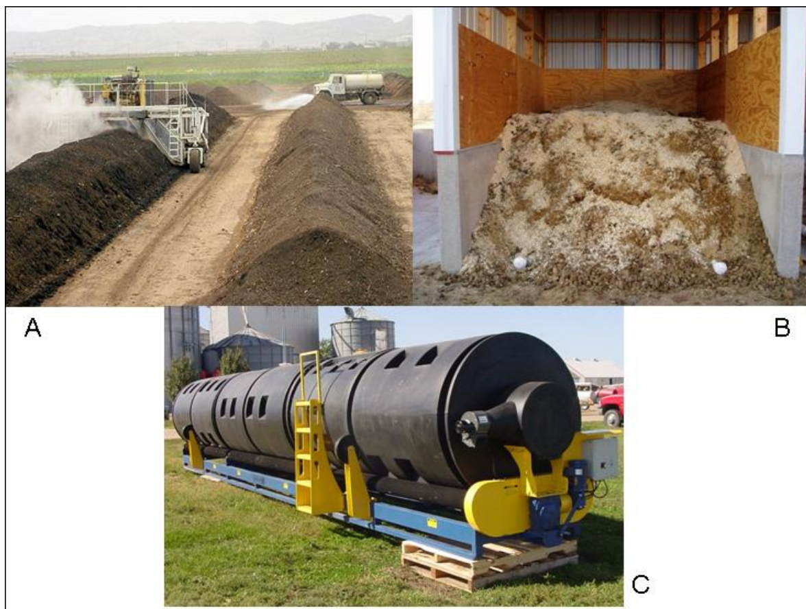
FIGURA 3 - DIFERENTES SISTEMAS DE COMPOSTAGEM. A – SISTEMA DE LEIRAS REVOLVIDAS, B- SISTEMA DE PILHAS ESTÁTICAS E C – SISTEMA DE COMPOSTAGEM EM REATORES.
