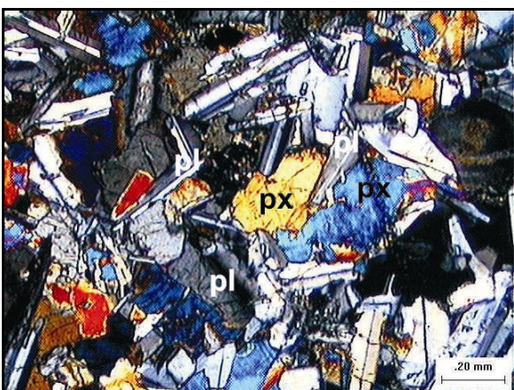
Figura 5.1: Fotomicrografia de diabásio equigranular fino subofítico (NX). Legenda: px=piroxênio, pl=plagioclásio.
