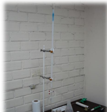
Figura 9 - Passagem de Blue Dextran para determinação de volume morto da coluna de gel-permeação. Fonte: o autor.
