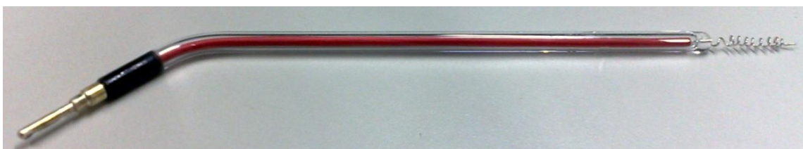
Figura 10: Contra eletrodo (CE) de platina ou eletrodo Auxiliar (GUGELMIN, 2009).
