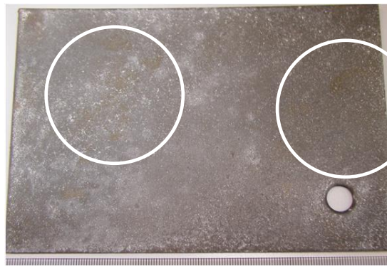
Figura 32. Imagem de uma placa de aço galvanizado após ensaio de Preece [96], demonstrando a não uniformidade do revestimento de zinco.
