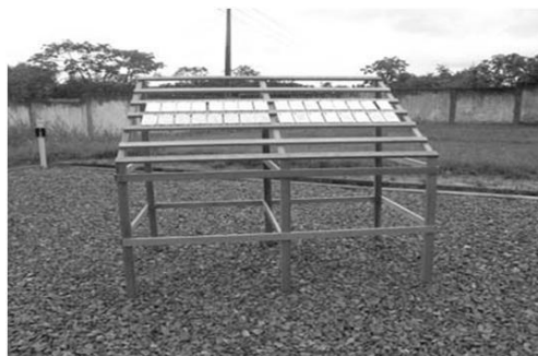
Figura 13. Painel de intemperismo natural da subestação de Camaçari-BA.
