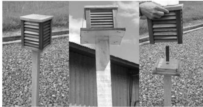
Figura 11. Vela coletora de sulfatos e suporte da vela.
