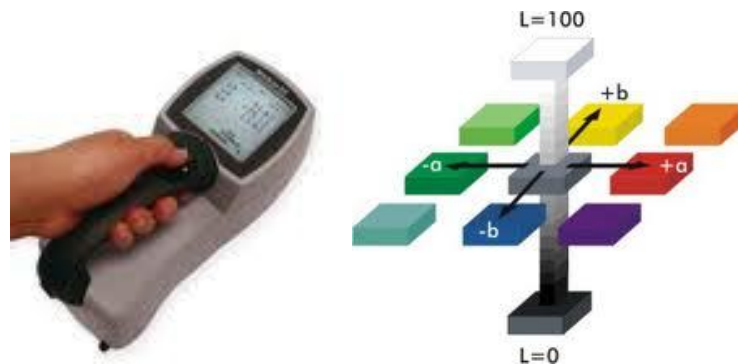
FIGURA 9 – EQUIPAMENTO PARA ANÁLISE DA COR - ESPECTROFOTÔMETRO HUNTER LAB MINI SCAN E SISTEMA CIELAB ( L^* , a^* , b^* ) FONTE: SITE – HUNTER LAB (2008)
