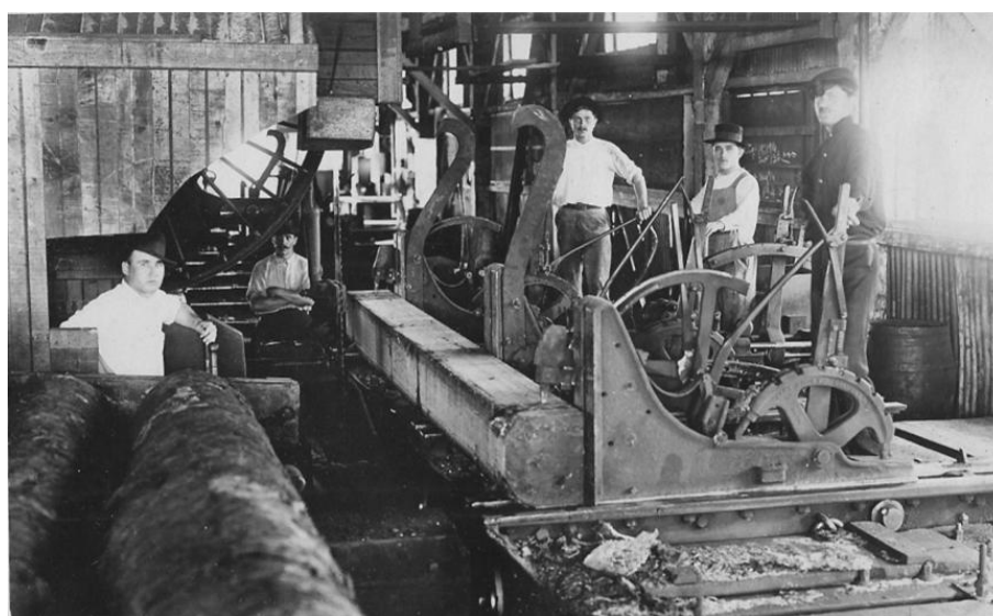
Figura 40 - Serra acoplada ao vagão “vai-e-vem”, 1913-1920. Fonte: Acervo da família de Claro Jansson – Itararé, imagem digitalizada por Rubens Habitzreuter
