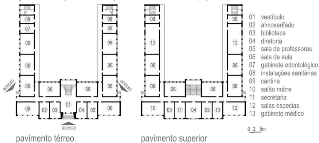
Figura 40: Plantas dos pavimentos térreo e superior da Escola Normal de Jacarezinho, depois Ginásio Estadual de Jacarezinho
