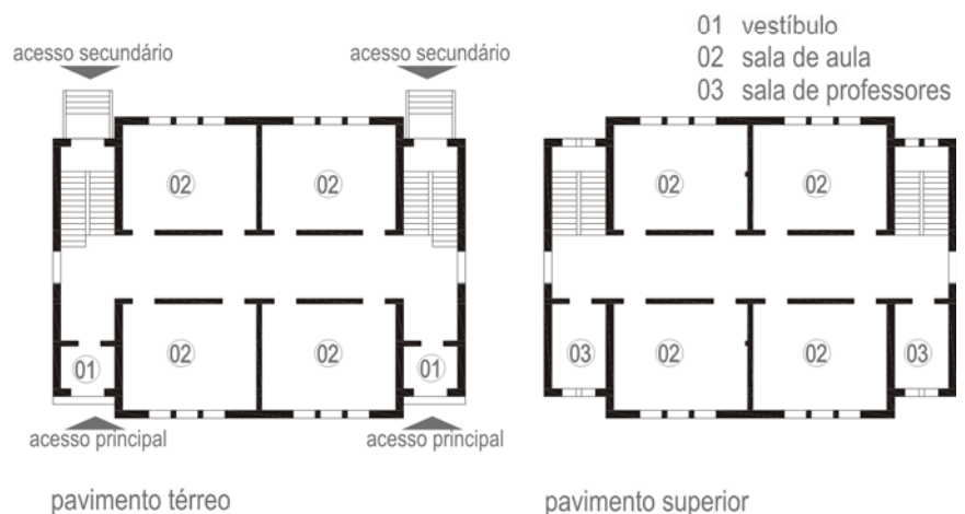
Figura 06: Plantas dos pavimentos térreo e superior do Projeto-tipo para Grupo Escolar de Victor Dubugras
