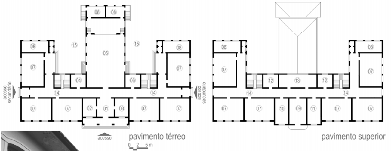
Figura 63: Planta do pavimento térreo do projeto-tipo de grupo escolar com doze salas de aula
