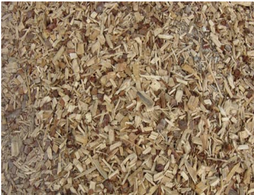
FOTO 21: CAVACO DE PINUS USADO PARA AQUECIMENTO DOS FORNOS DA CERÂMICA VERMELHA NA RMC FONTE: SENAI –SP (2010).
