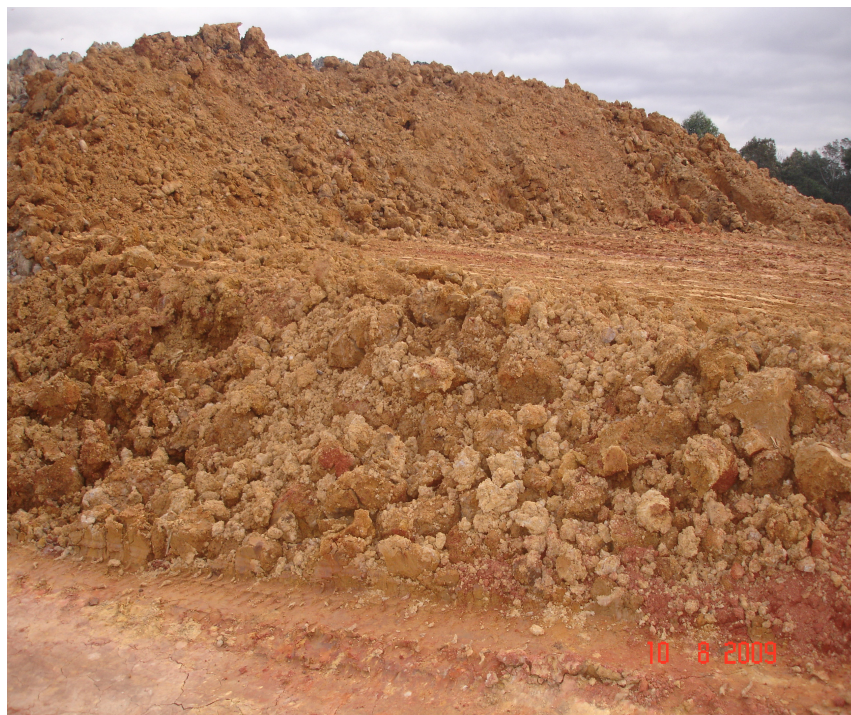
FOTO 2: SAZONAMENTO DE ARGILAS AFIM DE QUE OCORRA A DECOMPOSIÇÃO DE MATÉRIA ORGÂNICA FONTE: BONATO, 2009.
