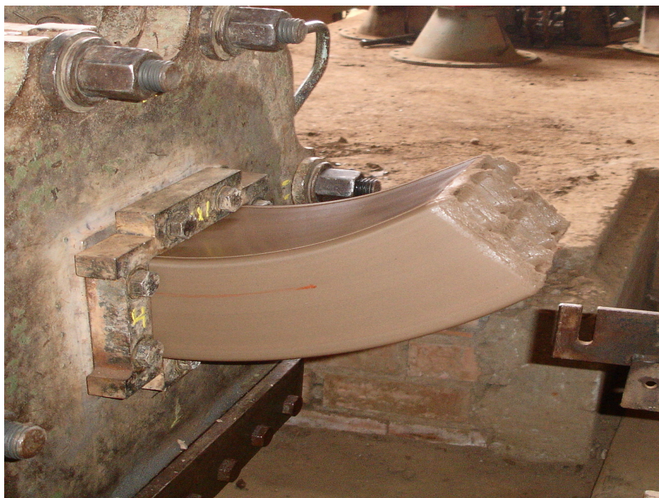
FOTO 8: DESAJUSTE NA VELOCIDADE DA EXTRUSORA, O QUE RESULTA EM TIJOLO EMPENADO QUE SERÁ DESCARTADO FONTE: BONATO, 2010.
