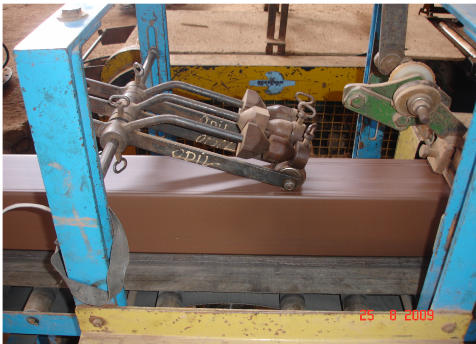
FOTO 10: IDENTIFICAÇÃO NAS PEÇAS CERÂMICAS ANTES DO CORTE FONTE: BONATO, 2010.
