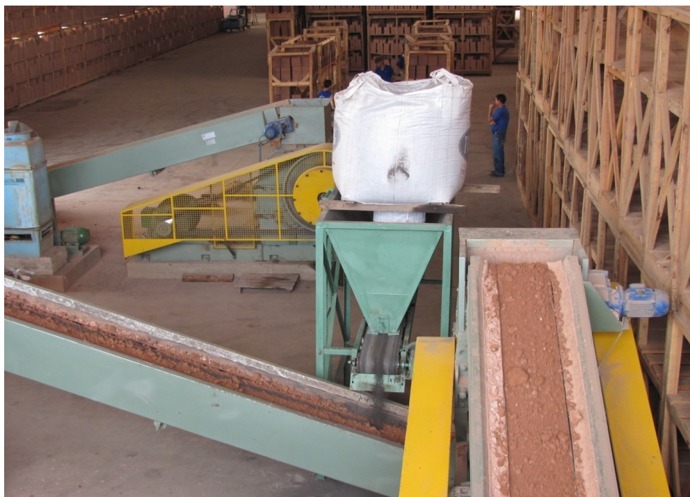
FOTO 20: ADIÇÃO DE CARVÃO MINERAL À MASSA CERÂMICA FONTE: ACERVO DE FOTOS CARBONÍFERA DO CAMBUÍ, 2010.
