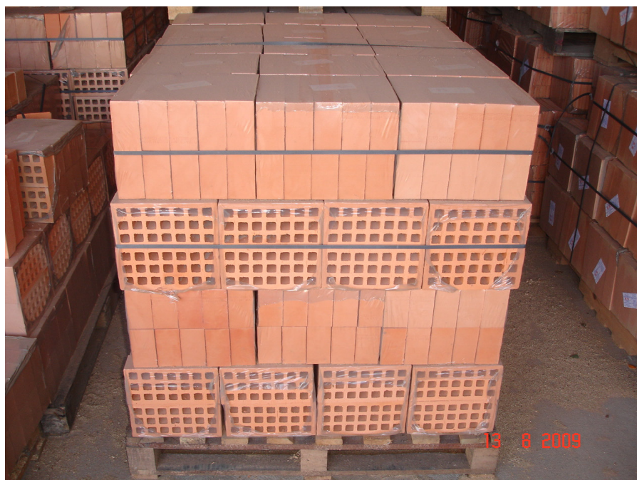
FOTO 19: TIJOLOS SOBRE PALETS, ARQUEADOS E EMBALADOS PARA SEREM ENTREGUES AO CONSUMIDOR FONTE: BONATO, 2009.
