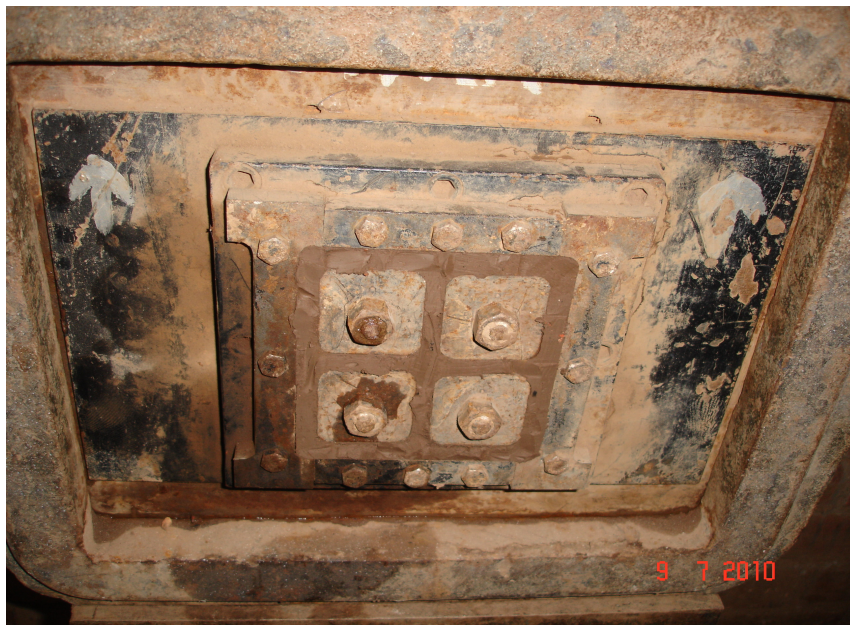
FOTO 7: BOQUILHA INSERIDA AO FINAL DA EXTRUSORA: FABRICAÇÃO DE TIJOLOS DE 4 FUROS FONTE: BONATO, 2010.
