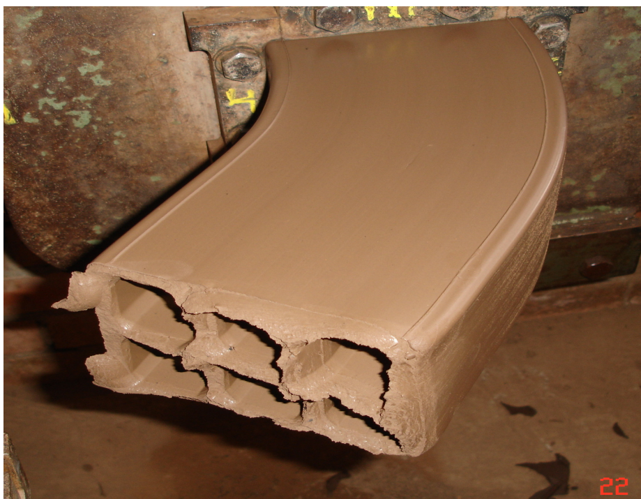
FOTO 9: DESAJUSTE NA VELOCIDADE DA EXTRUSORA, O QUE RESULTA EM TIJOLO CURVILÍNEO QUE SERÁ DESCARTADO FONTE: BONATO, 2010.
