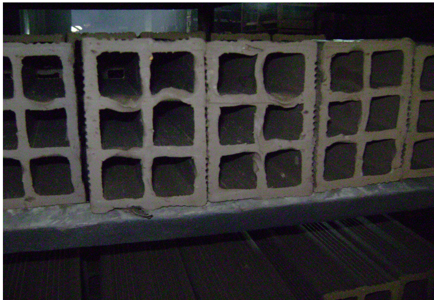
FOTO 13: EXCESSO DE UMIDADE NA MASSA E DEFORMAÇÃO DOS SEPTOS DOS TIJOLOS FONTE: MINEROPAR, 2010.
