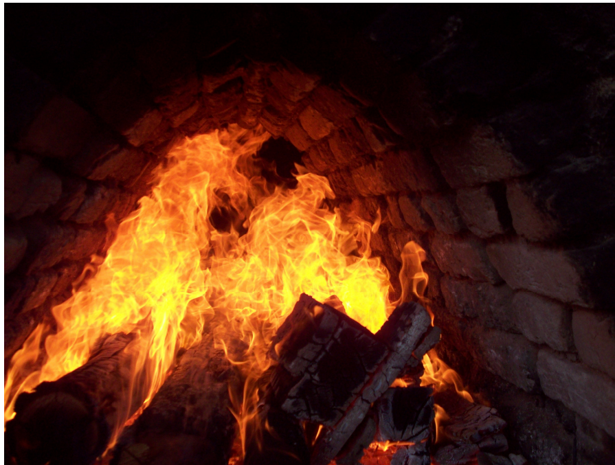
FOTO 16: ACIONAMENTO DO FORNO COM FOGO FORTE, FAZENDO USO DE LENHA FONTE: BONATO, 2010.
