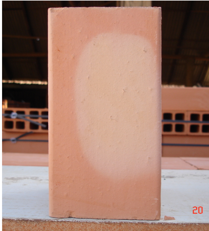
FOTO 4: MANCHA NO TIJOLO APÓS QUEIMADO CAUSADAS PELA PRESENÇA DE MATÉRIA ORGÂNICA NA MATÉRIA PRIMA UTILIZADA. FONTE: BONATO (2010).
