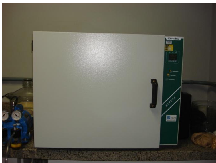
Figura 3.1 - Estufa de Esterilização e Secagem da Série 400ND
