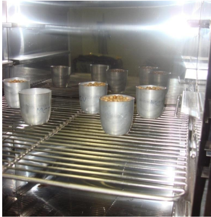
Figura 4.7 - A soja nos cadinhos sendo colocado na estufa em uma temperatura de 130°C +/-3 °C
