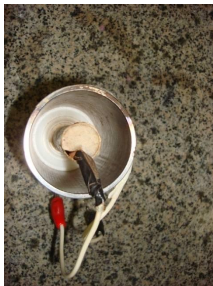
Figura 4.2 - Capacitor Cilíndrico de Base de Polipropileno.
