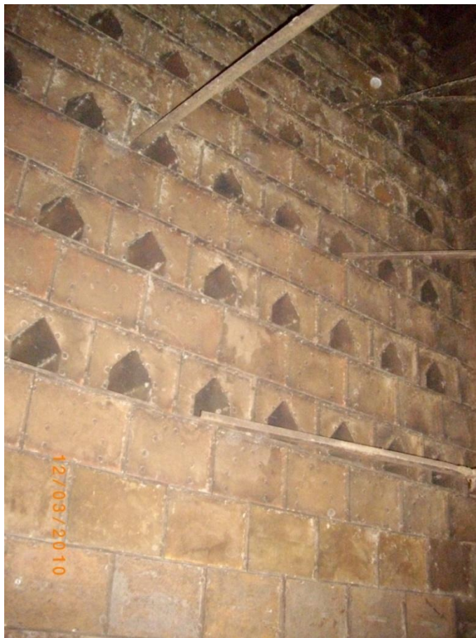
Figura 2.5 - Imagem do interior do Secador do Tipo Fluxo Misto em Torre
