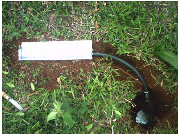
Figura 18- Calha coletora de Gerlach (50 cm), instalada na Mata de Araucária Foto. Antoneli, V. (2010).
