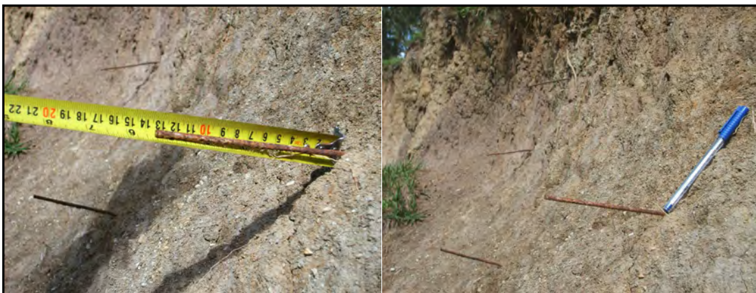
Figura 5- Procedimento da mensuração dos pinos nos barrancos das estradas.
