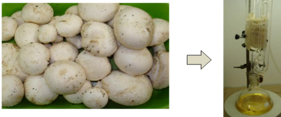
FIGURA 7 – COGUMELOS COMO OBTIDOS DO PRODUTOR (A) SUBMETIDOS AO PROCESSO DE DESLIPIDIFICAÇÃO EM CONJUNTO EXTRATOR SOXHLET (B)
