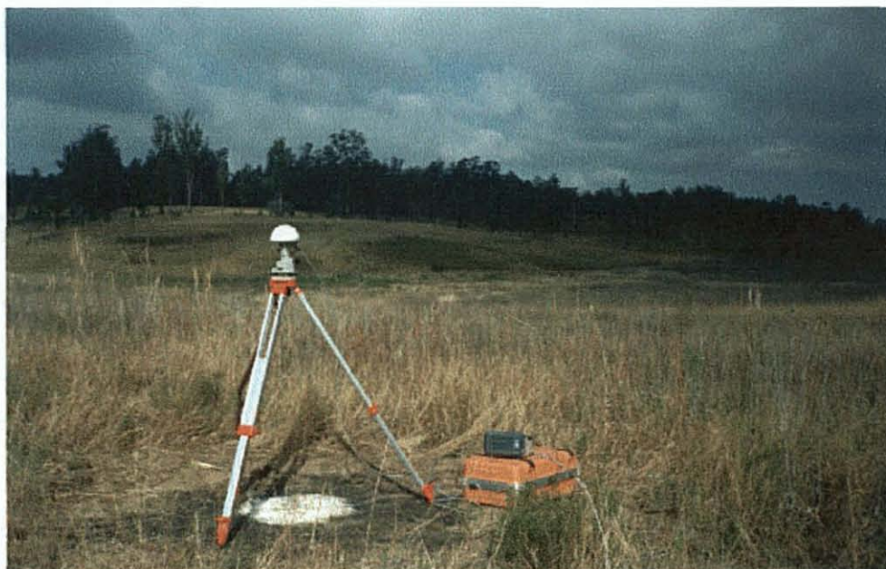
FIGURA 2 – LEVANTAMENTO DAS COORDENADAS DOS PONTOS DE APOIO TERRESTRES
