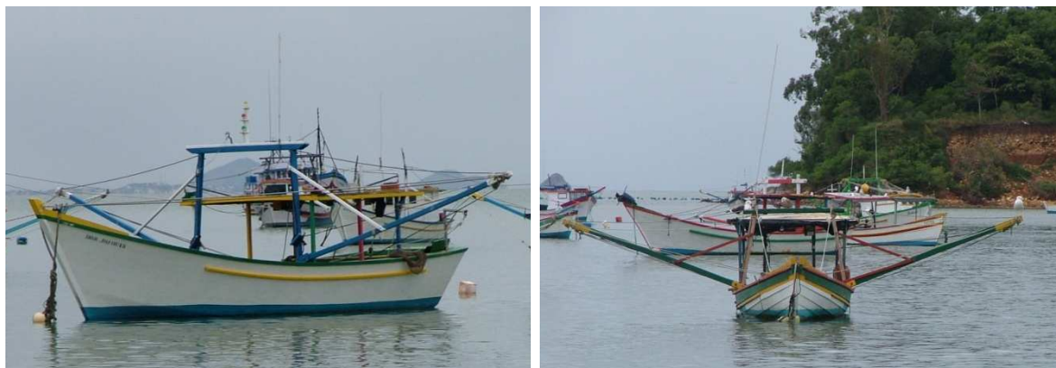
Figura 4: Embarcações utilizadas na pesca do camarão-sete-barbas, Armação de Itapocoroy município de Penha, SC. As embarcações trabalham em arrasto duplo e operam com dois tangones.
