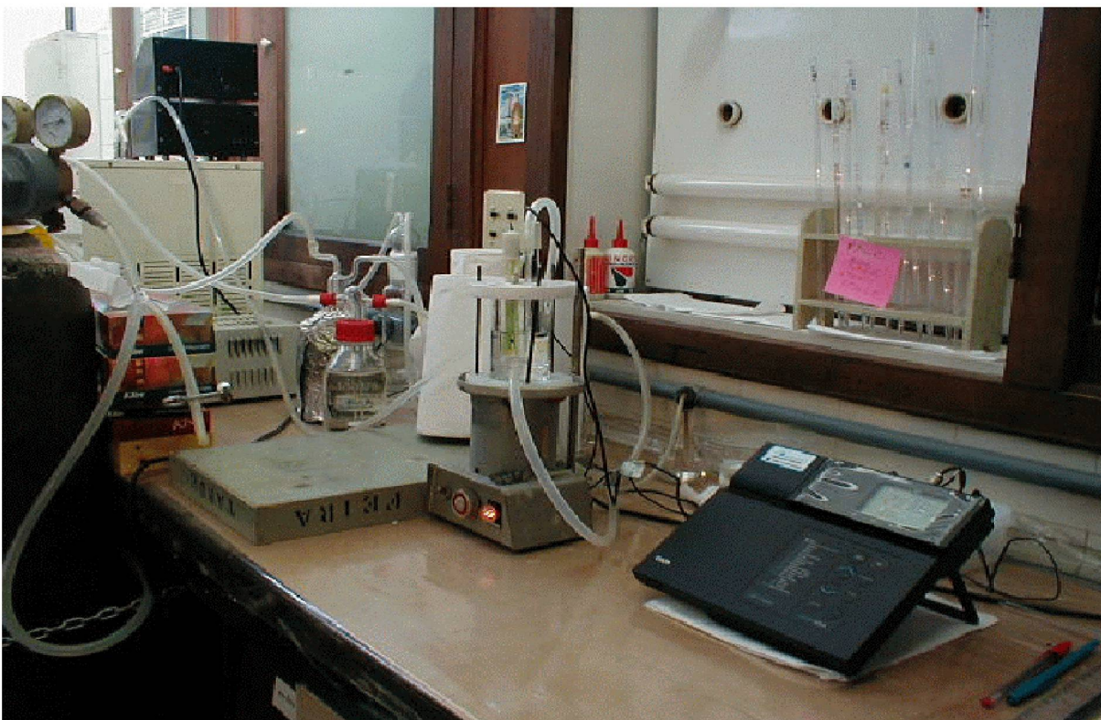
Figura 2- Sistema de Titulação Potenciométrica existente no Laboratório de Equilíbrio Químico, Departamento de Química (UFPR).
