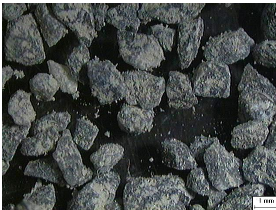
FIGURA 4.9 - IMAGEM CAPTURADA DA FRAÇÃO RETIDA NA PENEIRA DE MALHA 0,6 mm ATRAVÉS DE LUPA ELETRÔNICA – AGREGADO MIÚDO DE BRITAGEM (C1) FONTE: O autor (2009)
