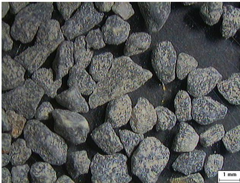
FIGURA 4.10 - IMAGEM CAPTURADA DA FRAÇÃO RETIDA NA PENEIRA DE MALHA 0,6 mm ATRAVÉS DE LUPA ELETRÔNICA – AGREGADO MIÚDO DE BRITAGEM (C2)
