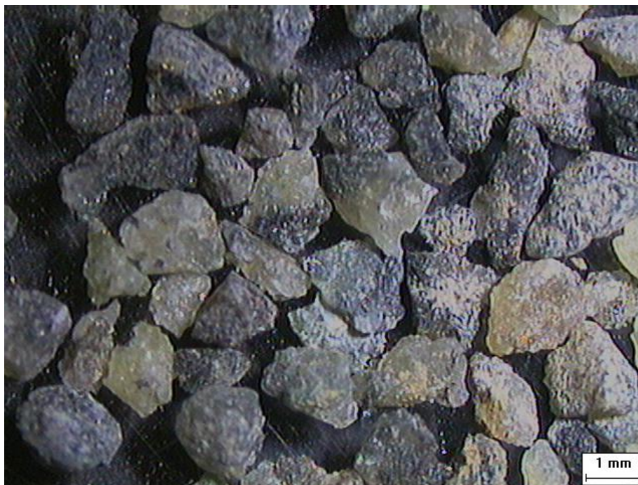
FIGURA 4.8 - IMAGEM CAPTURADA DA FRAÇÃO RETIDA NA PENEIRA DE MALHA 0,6 mm ATRAVÉS DE LUPA ELETRÔNICA – AGREGADO MIÚDO DE BRITAGEM (M) FONTE: O autor (2009)
