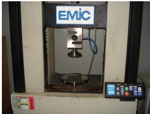
FIGURA 2.10 – FOTO DA PRENSA UNIVERSAL DE ENSAIOS EMIC MODELO DL 10.000 UTILIZADA NO ENSAIO “SQUEEZE FLOW”, NO LABORATÓRIO DE MATERIAIS E ESTRUTURAS – LAME FONTE: O autor (2009)
