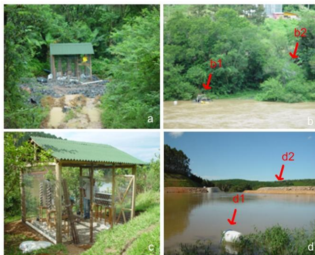
FIGURA 12 - Pontos de coleta de água do rio Itajaí-Açu, construção da Usina Hidrelétrica de Salto Pilão, Ibirama – SC. Estação de corrosão a jusante da UHE no Rio (a); Boia que mantém o ponto de sucção da água para as caixas acrílicas no ponto a jusante da UHE no Rio – b1 e localização da estação na margem do rio – b2 (b); Estação de corrosão a montante da UHE no Rio (c); Boia que mantém o ponto de sucção de água para as caixas acrílicas no ponto a montante da UHE no Rio – d1 e ensecadeira para a construção da barragem a montante da UHE no Rio – d2 (d).
