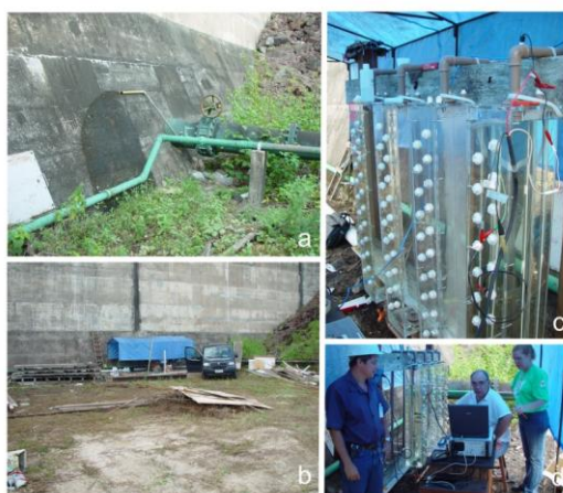
FIGURA 15 – Vista do pé da barragem onde foram instalados os corpos de prova do ponto de coleta “A” segundo figura 11. Tubulação de tomada de água do reservatório que transporta água para a vila e tanques de criação – peixe boi, ariranha, tartaruga, peixes e fornece água para a caixa acrílica – antes da instalação da estação de corrosão (a), visão geral da área onde se encontra instalada a estrutura do ponto A – depois da instalação da estação de corrosão (b), caixas operando com os corpos de prova já instalados (c) e Prof Dr. Carlos Mario Garcia realizando as medidas eletroquímicas para avaliar a corrosão das ligas (d).
