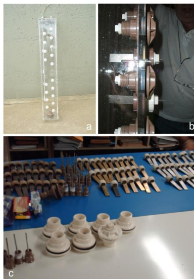
FIGURA 14 – Material utilizado para a confecção dos pontos de coleta. Caixa de acrílico que comporta os corpos de prova e eletrodos de medição (a), instalação dos corpos de prova (b) e visão geral do material antes da instalação (c).
