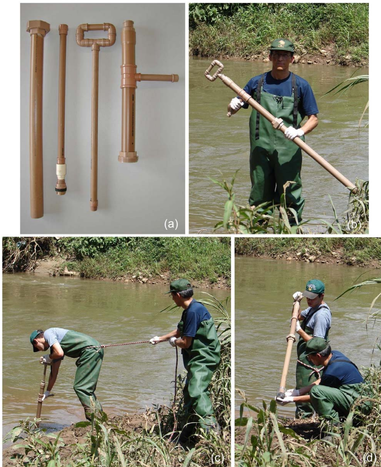
Figura 10. Aparelho em PVC desenvolvido para a coleta de amostras de sedimento: (a) partes integrantes; (b) montado com tubo coletor de 50 mm de diâmetro, (c) e (d) em uso na campanha de coleta no rio Barigui, em Araucária.
