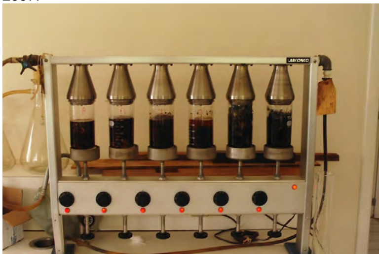
FOTOGRAFIA 12 – DECOÇÃO EM SISTEMA FECHADO DO MATERIAL VEGETAL COM O USO DE UM DIGESTOR DE FIBRAS. PONTA GROSSA, PR, 2007.
