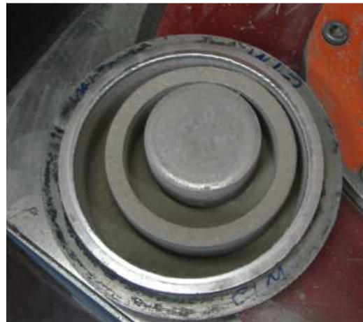
Figuras 15 e 16 – Equipamento de moagem centrífuga com discos excêntricos.
