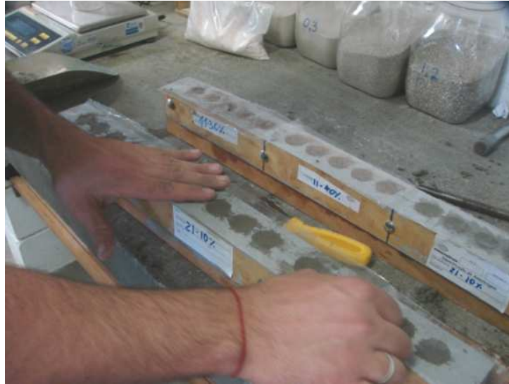
Figura 38 – Proteção dos corpos-de-prova contra evaporação.
