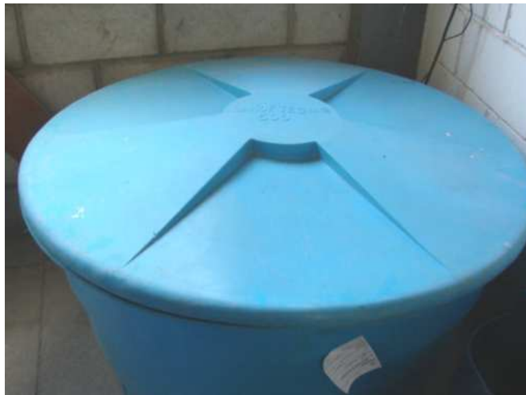
Figura 31 – Foto da caixa de cura térmica com a tampa superior.
