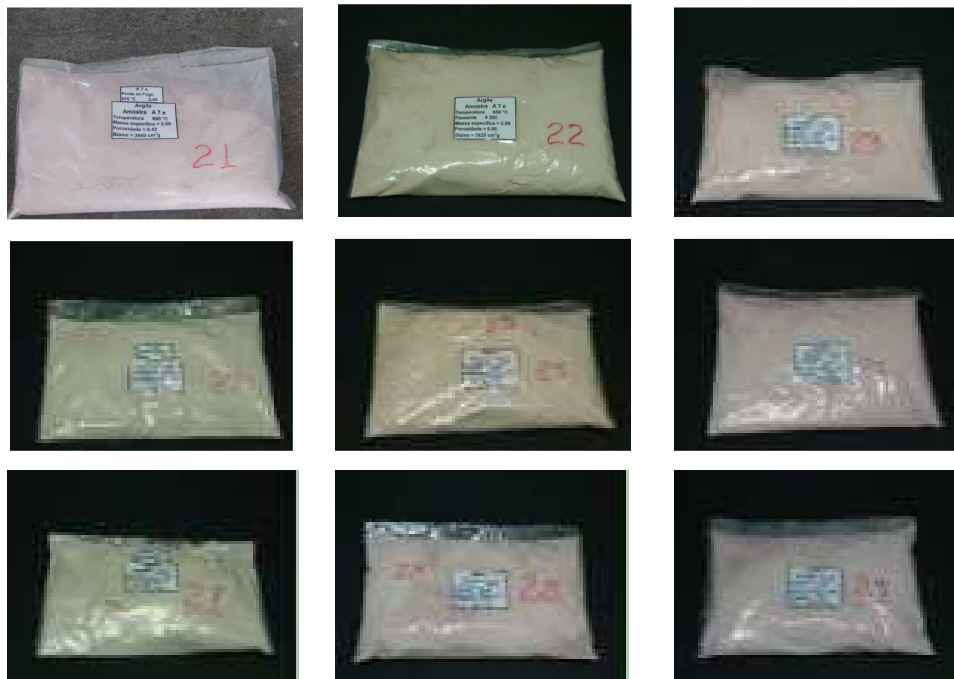
Figura 27 – Amostras da argila A7e separadas pela temperatura de calcinação e grau de finura.
