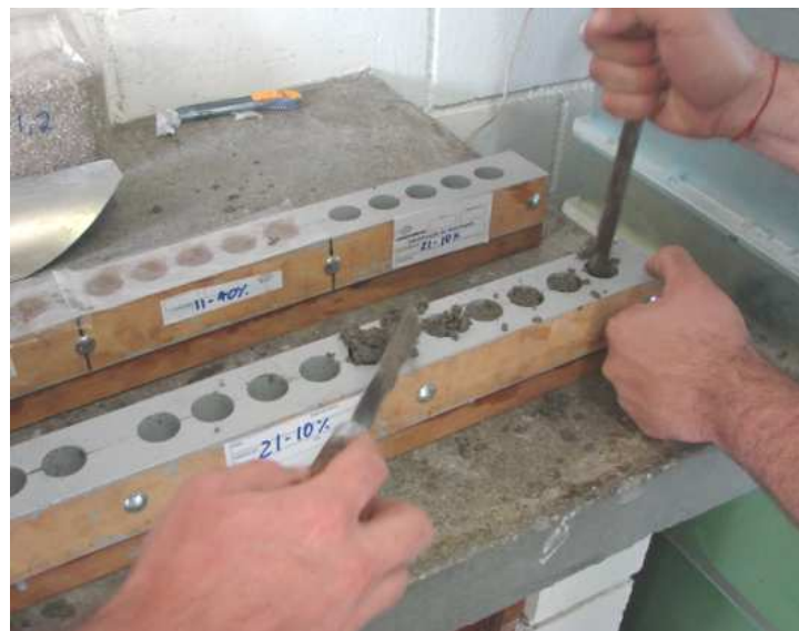
Figura 37 – Adensamento com soquete de aço de 10 mm de diâmetro.
