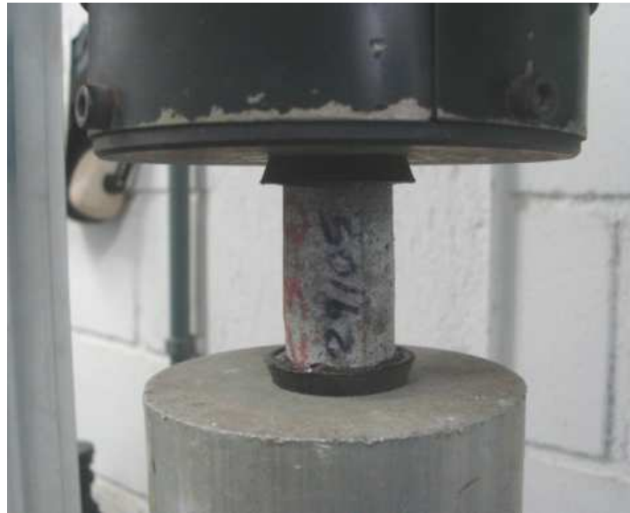
Figura 49 – Detalhe do posicionamento do corpo-de-prova na prensa de ensaio.
