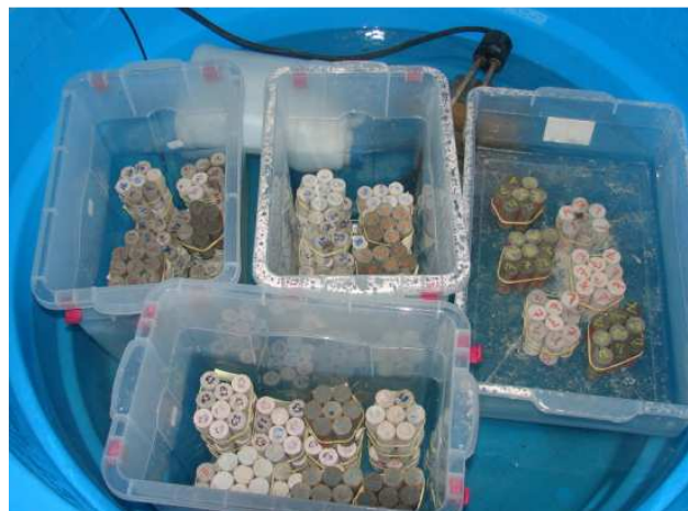
Figura 44 – Detalhe da caixas abertas flutuando na água aquecida a 38^{\circ}\text{C} \pm 2^{\circ}\text{C} .
