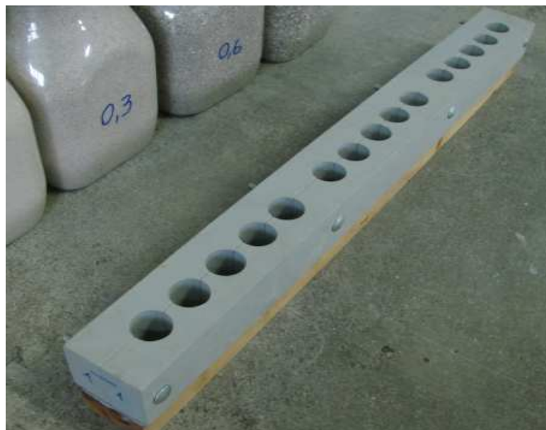
Figura 29 – Foto da fôrma de madeira com pintura em tinta epóxi.
