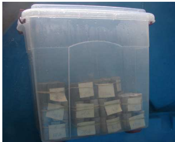
Figura 43 – Caixa fechada mantendo os corpos-de-prova em cura seca e aquecida.
