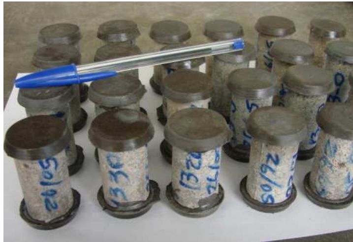
Figura 47 – Detalhe de uma série de exemplares devidamente capeados com enxofre.
