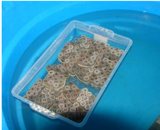
Figura 42 – Recipiente flutuante contendo os cps dentro da caixa de cura térmica.
