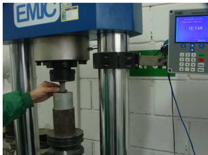
Figura 48 – Colocação do corpo de prova na prensa para ensaio de compressão.
