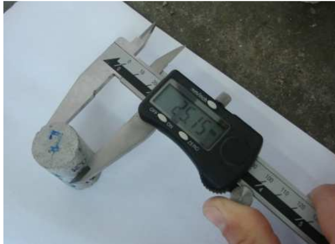
Figura 45 – Medição do diâmetro do exemplar com paquímetro com leitura digital.
