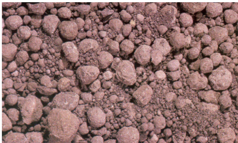
Figura 2 – Foto do clínquer em estado solto.
