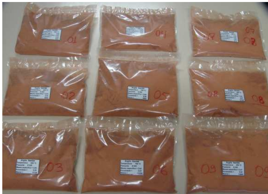
Figura 26 – Amostras da argila A3 separadas pela temperatura de calcinação e grau de finura.
