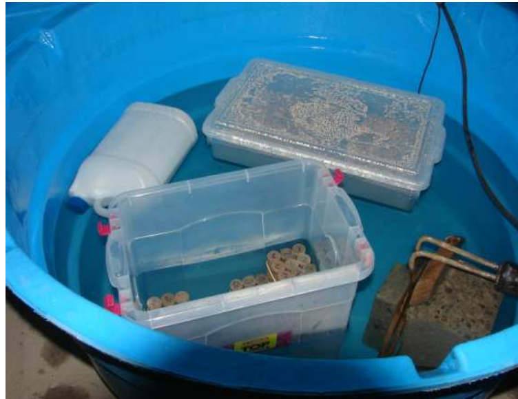
Figura 30 – Foto da caixa de cura térmica em banho com água aquecida.
