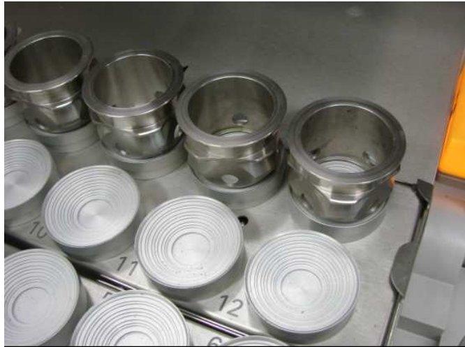
Figura 19 – Detalhe dos suportes das pastilhas do equipamento de raios-x automatizado.
