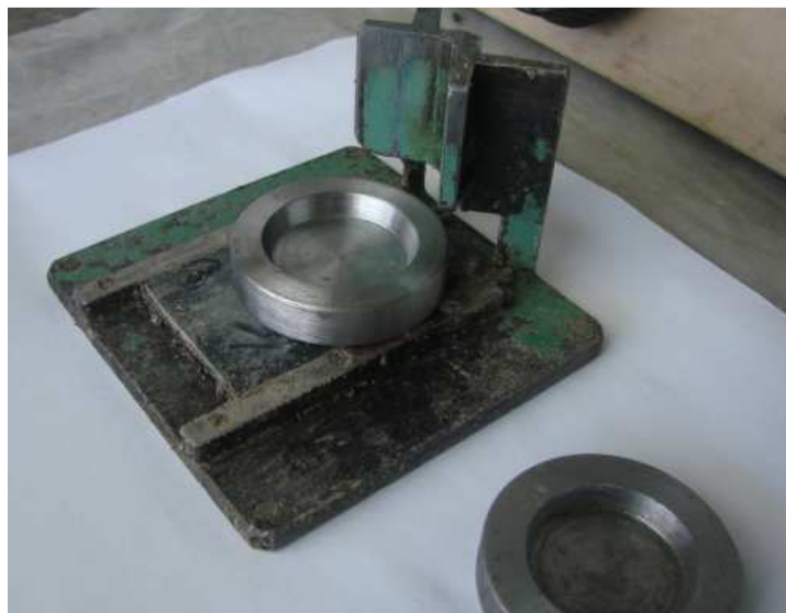
Figura 46 – Detalhe do capeador feito em aço com torno mecânico.
