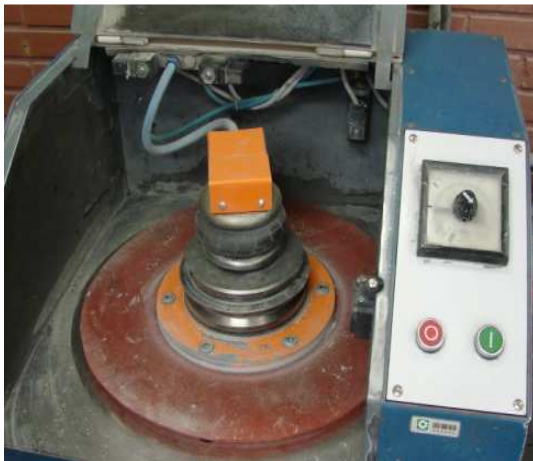
Figuras 15 e 16 – Equipamento de moagem centrífuga com discos excêntricos.
