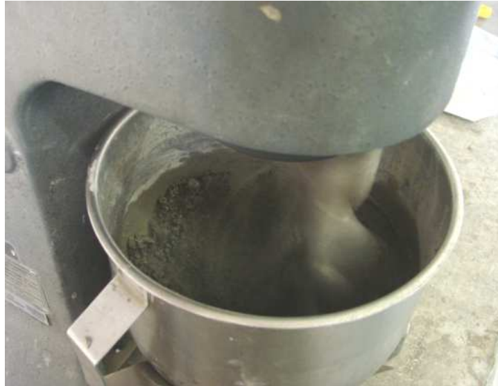
Figura 36 – Mistura da argamassa em misturador mecânico – NBR 7215:1996.
