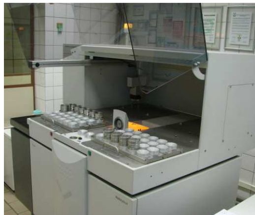
Figura 18 – Equipamento de ensaio de Raios-x.
