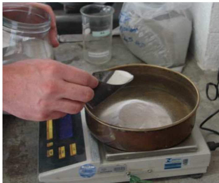
Figura 33 – Pesagem de uma das frações de areia padrão ABNT em balança eletrônica.
