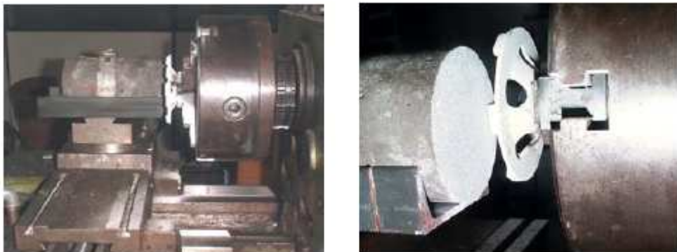
Figuras 6.9 e 6.10 - torno mecânico adaptado para a preparação de topos dos CPs (fonte: Mendes, 2002).
