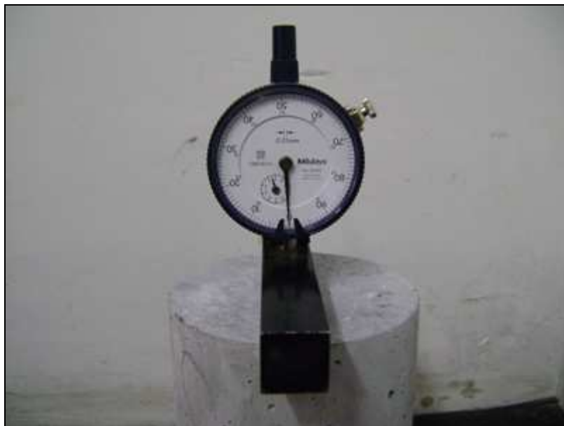
Figura 6.14 - extensômetro usado para verificação do topo dos CPs.
