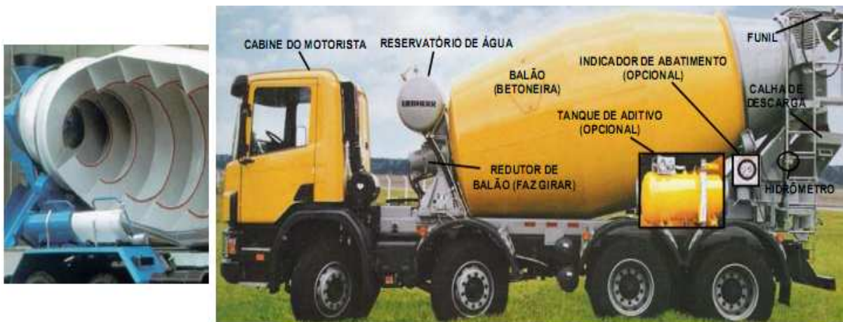
Figura 5.2 – a) sistema de facas b) representação do caminhão betoneira (fonte: catálogo Liebherr).
