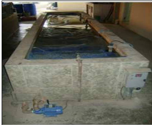
Figura 6.8 - tanque de cura.
