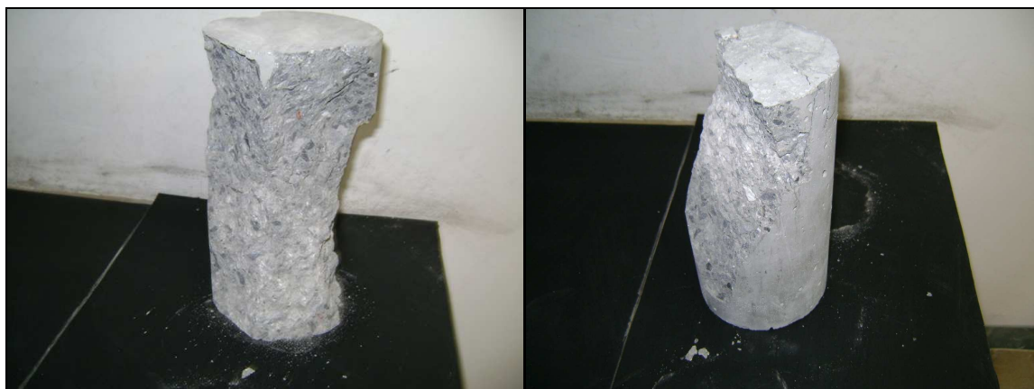
Figura 7.1 - CPs com ruptura cônica e com ruptura cisalhada.
