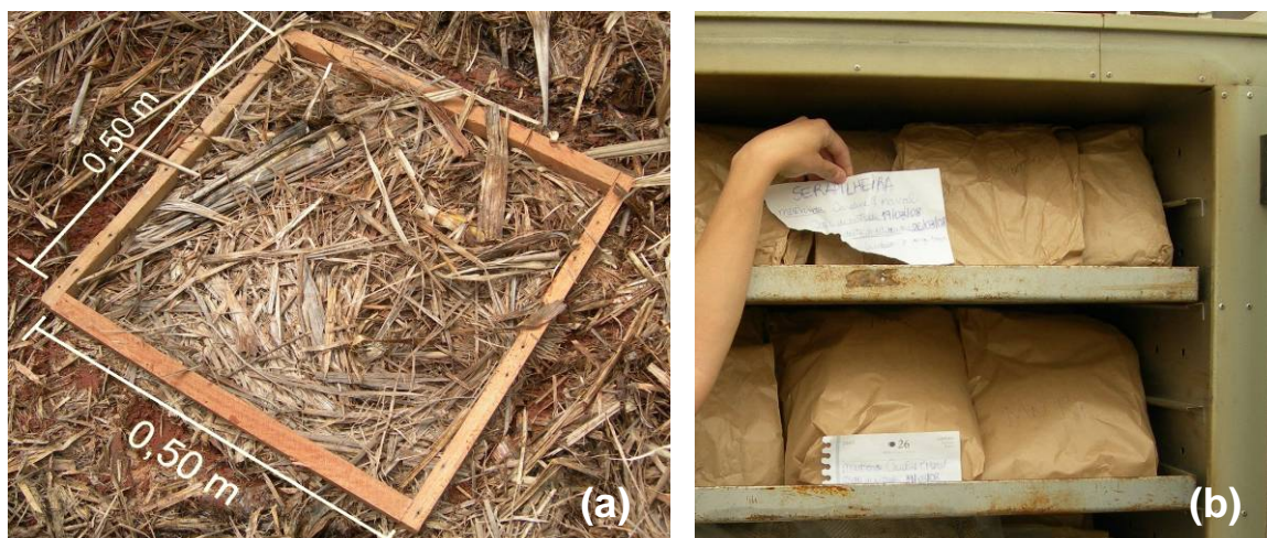
FIGURA 8 – DIMENSÕES DO GABARITO DE MADEIRA UTILIZADO NA COLETA (a) E SECAGEM EM ESTUFA (b) DA COBERTURA DE SOLO DAS ÁREAS DA USINA ALTO ALEGRE, MUNICÍPIO DE COLORADO, PR, NO ANO DE 2008
