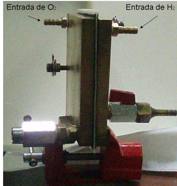
FIGURA 16 – MONTAGEM DA AMFC
