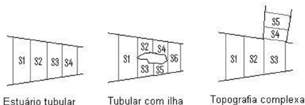
FIGURA 16 – Secionamento longitudinal de diferentes tipos de estuários
