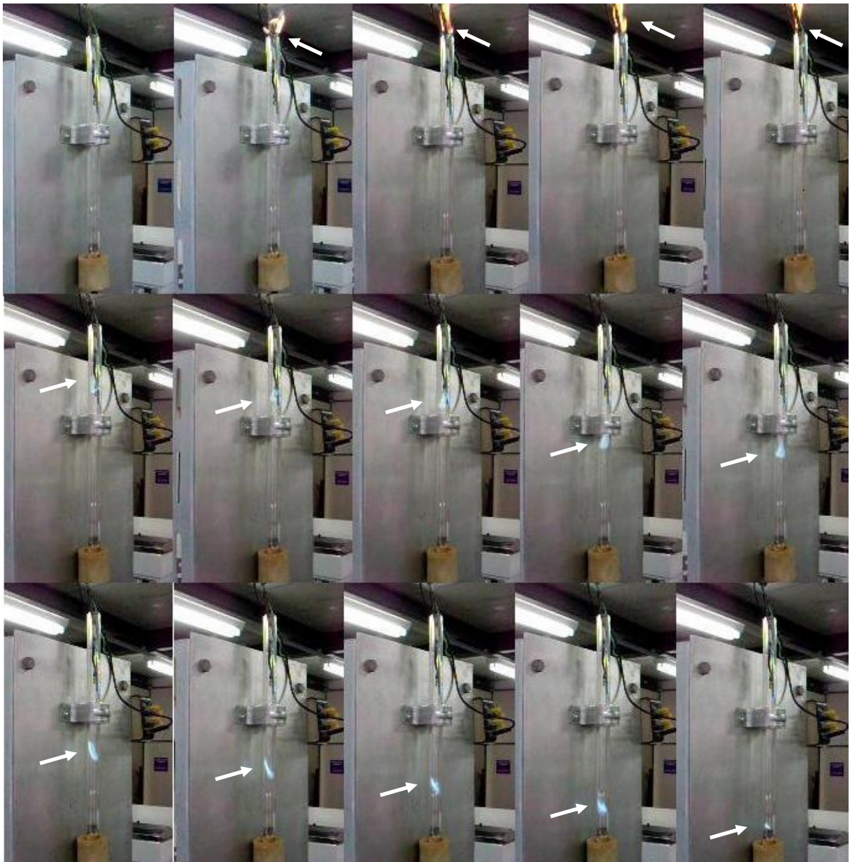
Figura 4.17 – Seqüência de um evento de inflamação em um tubo de combustão com mistura não-homogênea de gasolina e ar (intervalo de captura \leq 0,01 s) (velocidade de captura da filmagem \leq 100 quadros s^{-1} ). A chama provocada pela ignição da gasolina apresentou coloração azulada, o que a torna facilmente visível.
